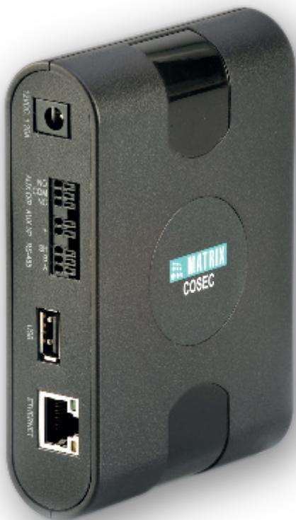
Le Nano serveur Panel Lite agit en standalone. Il est relié , via réseau IP, aux contrôleurs IP ou aux lecteurs/contrôleurs IP.
